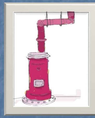
Yapısal olmayan tehlikelerin azaltılmasına yönelik sabitlenmiş eşya örnekleri
