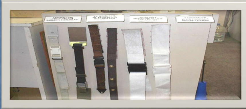
Yapısal olmayan tehlikelerin azaltılmasına yönelik sabitleme parçaları
